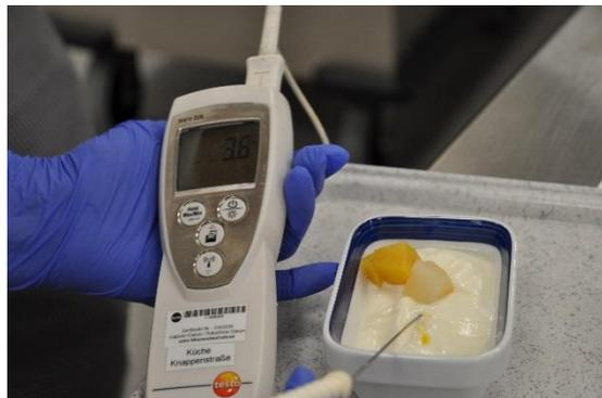
Messung der Kerntemperatur beim Portionieren
