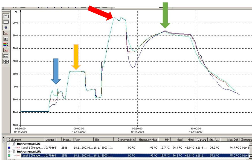
Typischer Temperaturverlauf im RDG beim thermischen Programm (Vario-Programm):
